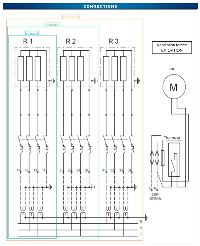
Dans cette section, nous observons à gauche le schéma de connexion des différents ensembles ARM. Nous pouvons différencier le schéma de connexion pour 1, 2 et / ou 3 groupes de résistances.
