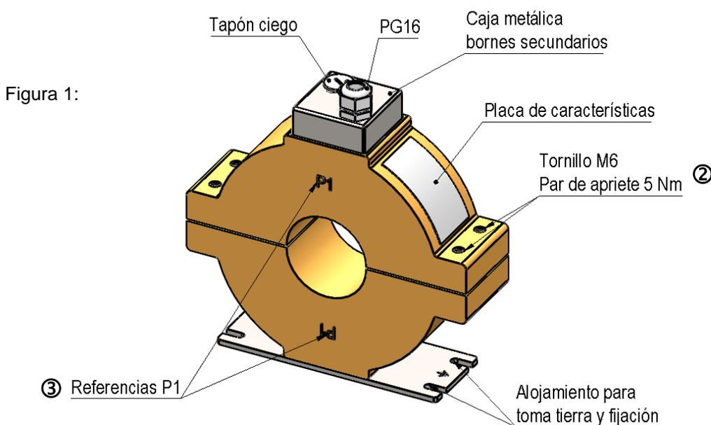
Antes de volver a montar, **verificar la limpieza de las caras polares** del circuito magnético.
