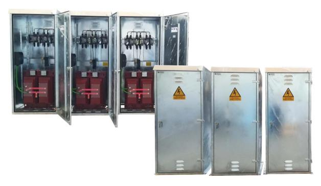
Ces cellules sont des armoires galvanisées, de 3,6 kV de tension nominale, destinés à centres de transformation avec double alimentation (de boucle), avec câbles jusqu'à 35 mm2 de section et une sortie protégée.
