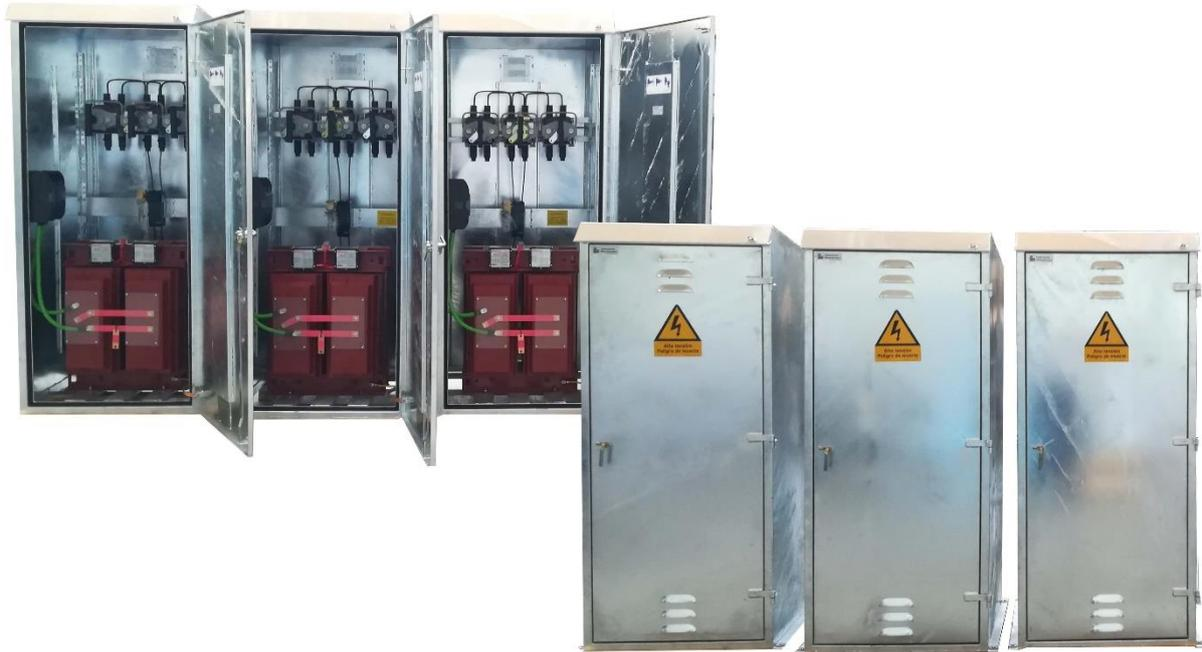
Armarios de tensión nominal de 3,6 kV, destinados a centros de transformación con alimentación doble (de bucle), con cables de hasta 35 mm<sup>2</sup> de sección y una salida protegida.
